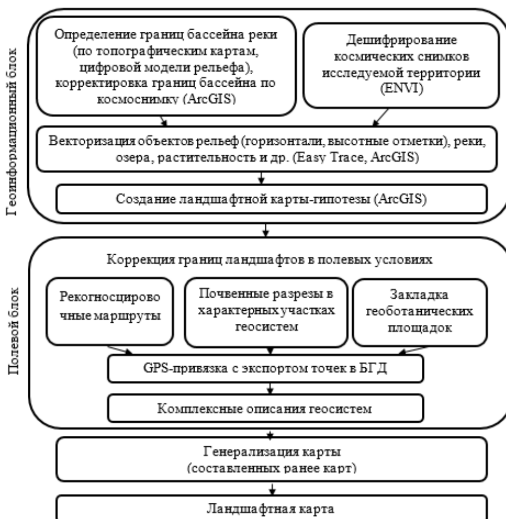
Рис. 1. Блок-схема геоинформационного картографирования ландшафтов
